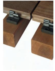
6. Bei der Ausbildung eines stumpfen Terrassendienenstoßes empfehlen wir, eine doppelte Unterkonstruktion anzuordnen.
