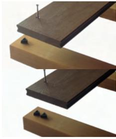
1. Anfangsteil an der Sollbruchstelle abtrennen und unter die erste Diele setzen. Bei allen Dielenbreiten <120mm ist ein Anfangsteil ausreichend, bei Dielenbreiten >120mm empfehlen wir zwei Anfangsteile zu unterlegen.
