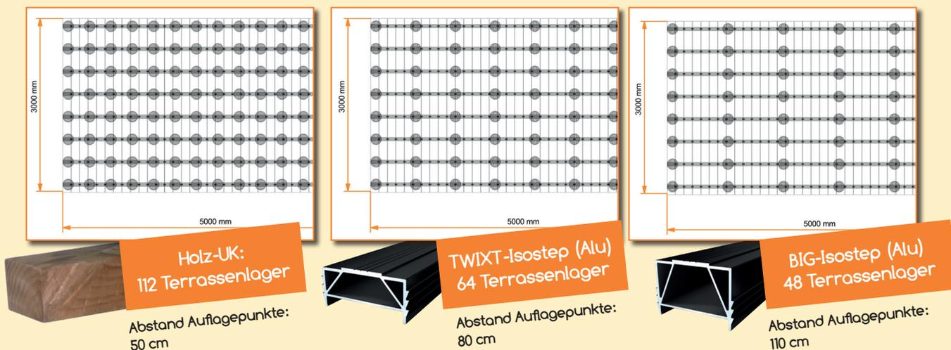
Durch den Einsatz einer Aluminium-Unterkonstruktion können bis zu 64 Terrassenlager eingespart werden!
