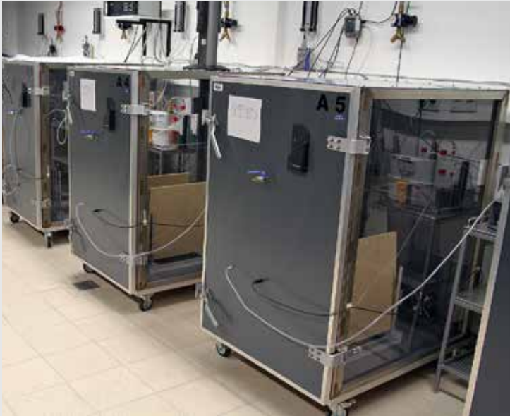
Prüfkammern der 1-m 3 -Kammer-Bauart beim Fraunhofer-Institut WKI.
