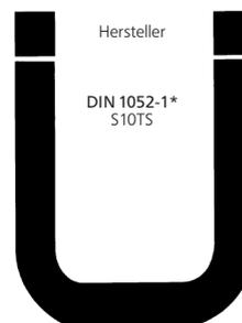
B Zusätzlich bei KVH® mit Keilzinkenverbindung laut DIN 68140-1 auf dem Produkt: Hersteller, Fertigungstag, Holzfeuchtegrenze, Bezeichnung der Keilzinkenverbindung, Sortierklasse, Zeichen der fremdüberwachenden Stelle.
