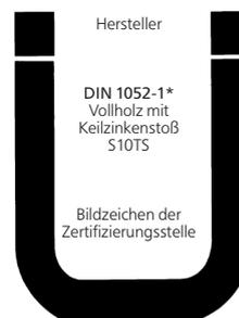
\* Nach der bauaufsichtlichen Einführung der DIN 4074 entfällt der Bezug zur DIN 1052. Die Kennzeichnung enthält dann die Angabe: DIN 4074-1 – S 10 TS oder S 13 TS
