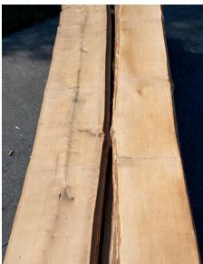
Wird als unbesäumte Blockware oder Bohlen verkauft. Leichte Abweichung der Faserneigung von der Richtung der Längsachse des Holzes toleriert.
