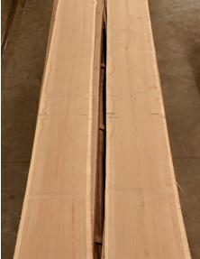
Blockware mit zwei Drittel sauberer Bohlen mit guter Geradlinigkeit, wenig Splintholz, annähernd gerader Faser und regelmäßigem Kern
