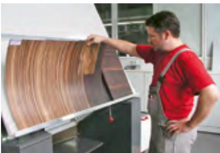
Die Entwicklung des Designs und der Druckvorlage benötigt bis zu vier Wochen. Das Dekorpapier wird im Tiefdruckverfahren gedruckt. Neuere Verfahren arbeiten auch mit Direktdruck auf die Trägerplatte.
