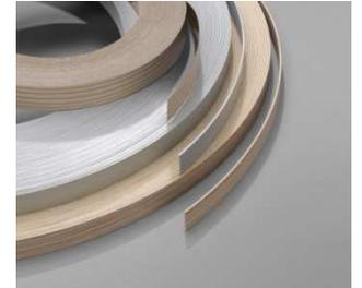
EGGER Sicherheitskanten ABS sind thermoplastische Kanten zur dekorativen Schmalflächenbeschichtung von Holzwerkstoffen und übernehmen eine Schutz- und Designfunktion. EGGER Sicherheitskanten werden aus ABS hergestellt und sind vollflächig durchgefärbt. Die Rückseite ist mit einem Universal-Haftvermittler (Primer) versehen.
