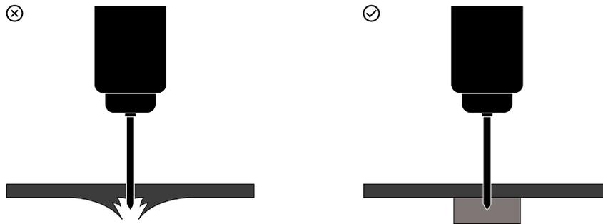
Große Bohrungen, z. B. für Suspension und Verriegelungsvorrichtungen, müssen mit Kombinationsbohrern gebohrt werden.
