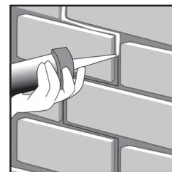
**5.** Ist die gesamte Oberfläche verkleidet, werden sowohl die Fugen als auch die Bohrlöcher mit Dichtungsmasse ausgefüllt.
