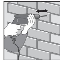
**3.** Wir halten das Paneel an die Wand und bohren gleichzeitig in Paneel und Wand ein Loch (Bohrergröße 6 mm). Anschließend schrauben wir das Paneel fest, bis die Schraube perfekt im Dübel eingesenkt ist (z.B. Dübel vom Typ "Fisher" von 6 mm und Schrauben von 4,5 x 40 mm). Es werden so viele Schrauben pro Paneel verwendet wie notwendig.
