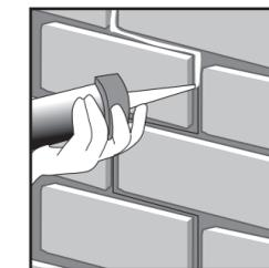
**5.** Dopo aver rivestito tutta la superficie, coprire con stuccatura i giunti dell'assemblaggio e i buchi del trapano.
