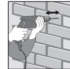
**3.** Porre il pannello sulla parete e trapanare contemporaneamente la parete e il pannello (mandrino di 6 mm). Successivamente, avvitare fino ad accoccare le viti (cuneo tipo "Fisher" di 6 mm e viti di 4,5 x 40 mm). Usare tutte le viti necessarie per ogni pannello.
