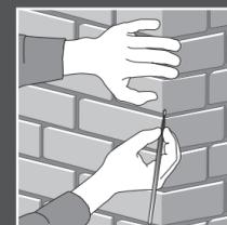
**E.** Sind die Fugen gefüllt, beseitigen wir mit Hilfe eines feinen Pinsels letzte Unebenheiten in der Dichtungsmasse.
