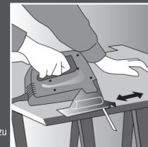
**C.** Mit der Dekupiersäge wird in 45° zu den Linien gesägt.
