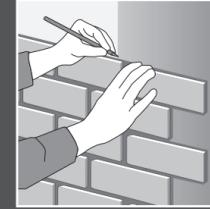
**A.** Gelangen wir bei der Verlegung an eine Ecke, markieren wir auf dem Panel die zu verwinkelnde Linie.
