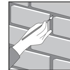
**6.** Dopo la stuccatura, passare un pennellino sottile all'interno dei giunti e dei buchi per livellare le irregolarità di altezza provocate dalla stuccatura. Fare asciugare bene (circa 24 ore) e, con la vernice per giunture Panespol, pitturare i giunti e/o buchi fino ad ottenere un risultato finale perfetto.
