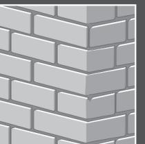
**F.** Fare asciugare lo stucco e verniciare le giunture con la vernice per ritocchi PANESPOL. Infine, ritoccare con polvere speciale PANESPOL per ottenere un impeccabile risultato finale.
