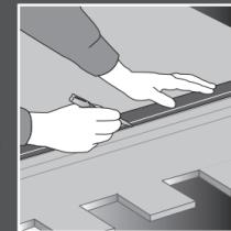
**B.** Zu dieser Linie ziehen wir in einem Abstand, der der doppelten Paneeldicke entspricht, eine Parallellinie (zwischen 2 und 4 cm, je nach Modell).
