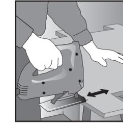
**2.** Prima di iniziare a lavorare, tagliare un'estremità dell'assemblaggio per ottenere un pannello dalla superficie retta.
