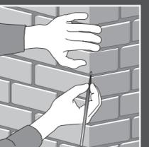
**E.** Dopo aver stuccato il giunto, passare un pennello sottile per livellare le irregolarità di altezza dello stucco.
