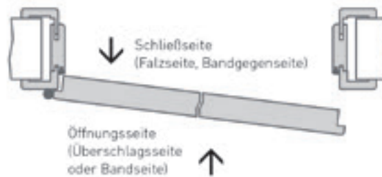
Anschlagrichtung links im Querschnitt
